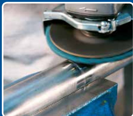
Шлифовка тонких сварных швов и удаление цветов побежалости
