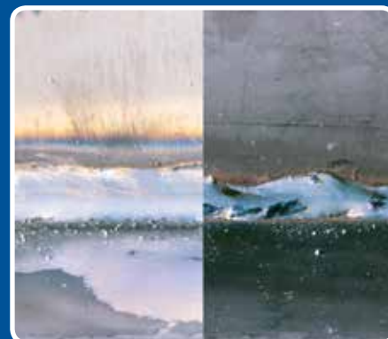
Удаление окалины перед сваркой обеспечивает чистый сварной шов (см. фото слева)
