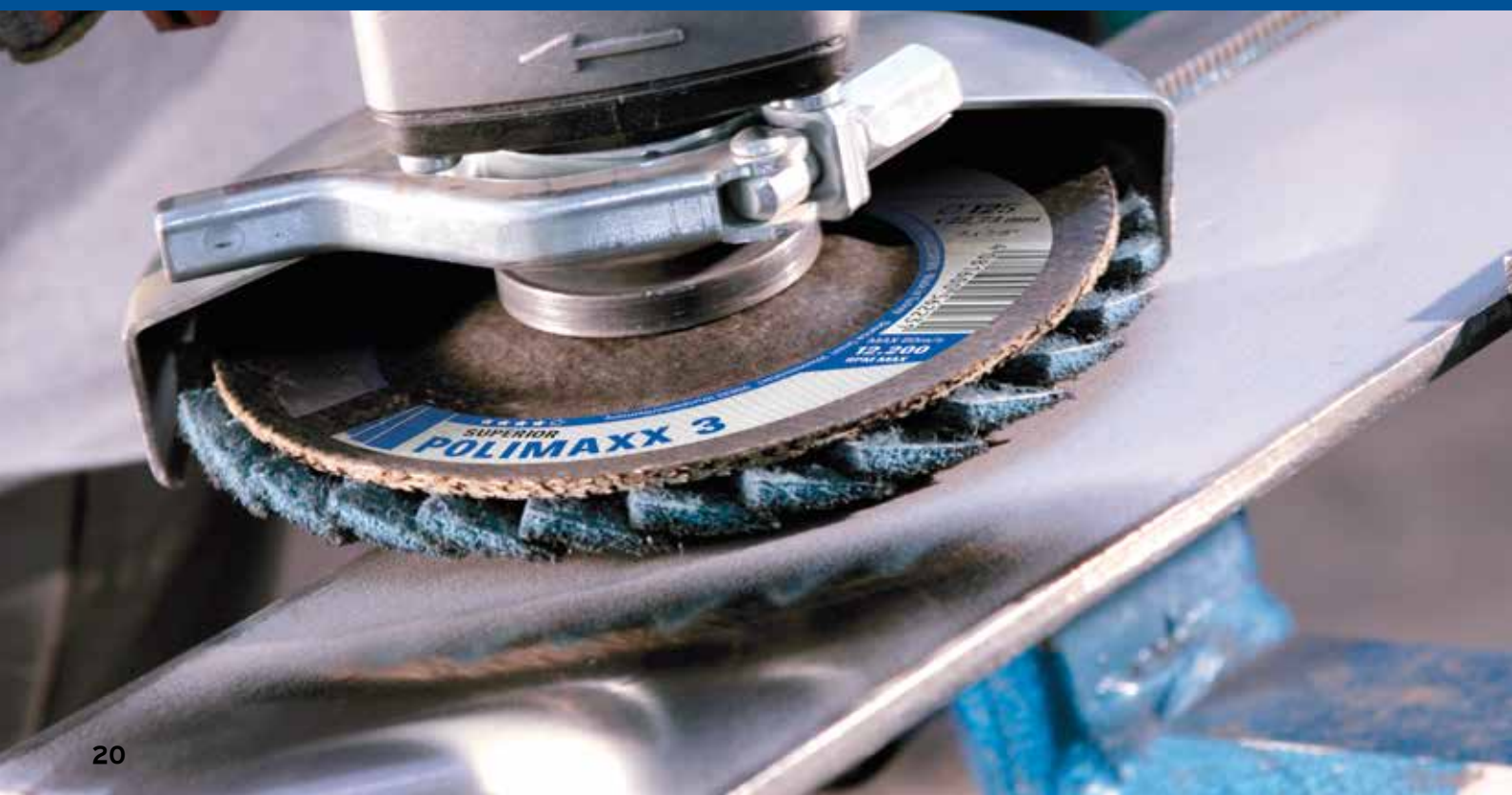
Шлифовка тонких сварных швов и удаление цветов побежалости
